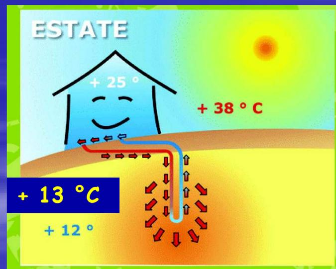
La pompa funziona trasferendo dal/al sottosuolo la maggior parte del calore scambiato nel ciclo, anziché produrlo!
